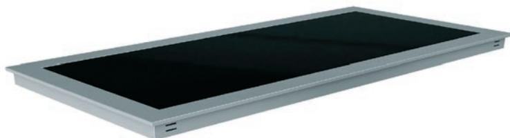
Piano refrigerato statico in vetro temperato nero da incasso, con gruppo integrato o predis-posto per gruppo remoto. Ideale per pasticceria. Realizzato in acciaio inox AISI 304, isolamento con schiuma poliuretanica iniettata. Raffreddamento statico. Regolazione della temperatura da +2°C ÷ +12°C con teletermostato digitale. Disponibile nelle dimensioni 2-3-4 EN.
